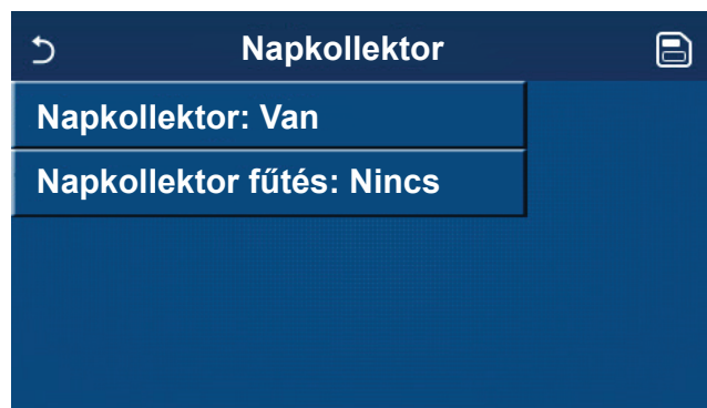
Napkollektor beállítások (Solar Setting)
